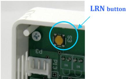
Для привязки устройства к приемникам актуаторам, нужно перевести соответствующий приемник в режим обучения согласно инструкции на приемник (обычно используя кнопку LRN) и произвести отправку обучающей радиотелеграммы однократным нажатием на радио кнопку LRN внутри корпуса EnCODE. При успешной привязке приемник реагирует на радиотелеграммы от датчика.
